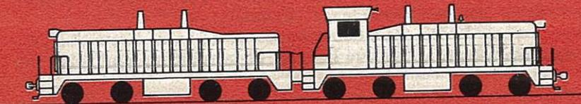
**COW-AND-CALF** (vache et veau) : loco de manœuvres + élément moteur pour triage et manœuvres.
