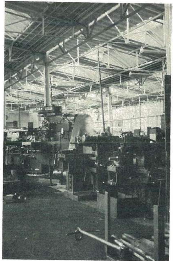
Fig. 35. — Commande individuelle des machines-outils (Ateliers E.S.-Etterbeek).
