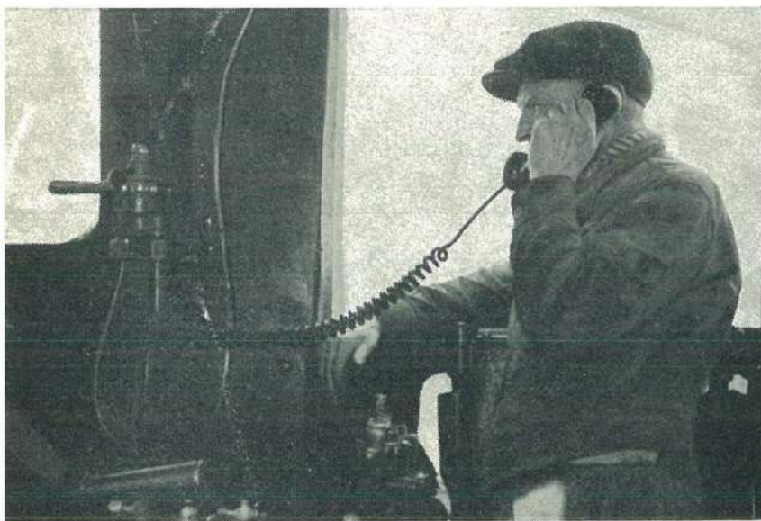
Fig. 25. — Poste émetteur-récepteur à bord d'une locomotive.
