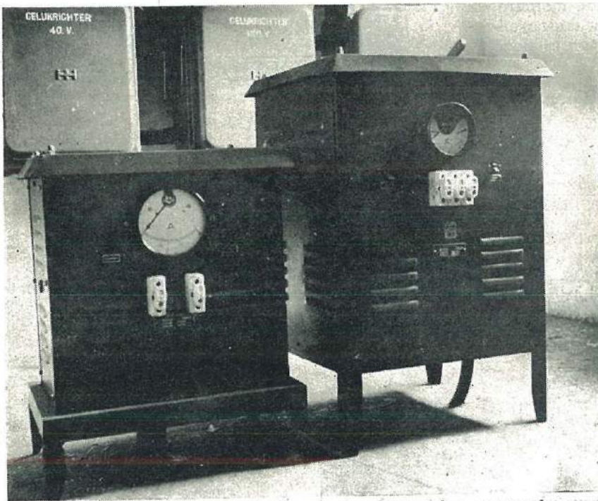
Fig. 37. — Redresseurs statiques remplaçant les accumulateurs.
