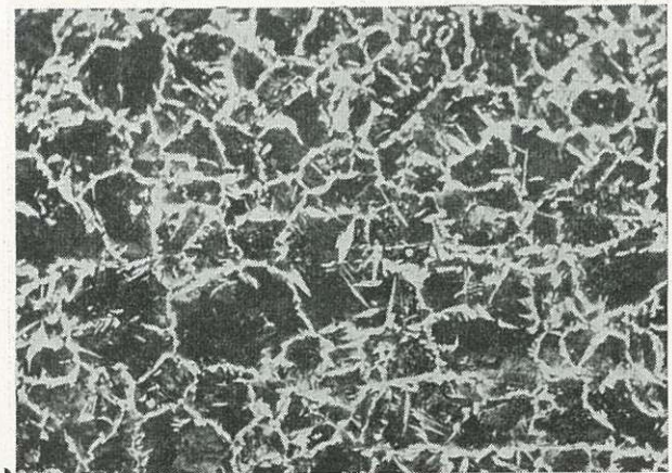
Fig. 31. — Structure normale du rail - 100 x.
