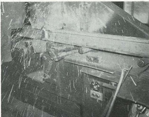
Fig. 28. — Chauffage et fusion par rapprochements et reculs.
