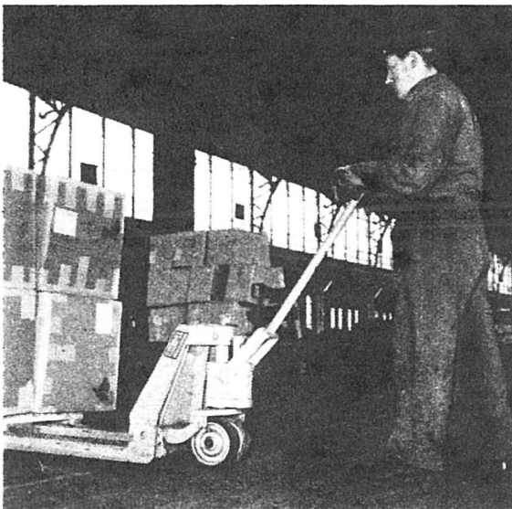
HYDRAULISCHE PALLETTRUCK (N° 1150 TOT 1199). Laadvermogen : 1.000 kg. Hefhoogte : 10 cm
