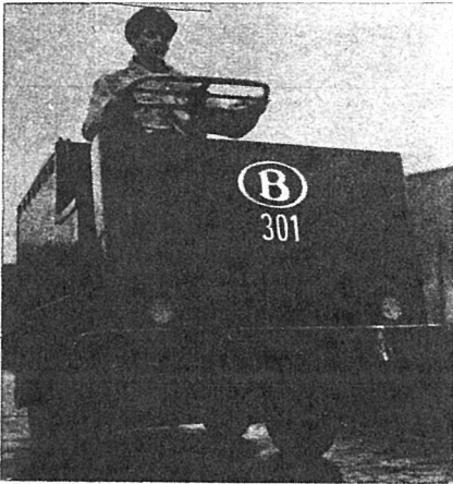
VIERWIELIGE ELEKTRISCHE TRACTOR (N° 301 TOT 310). Snelheid : 10 km/h. Gewicht : 2.690 kg. Hij kan een stel driewielers van twaalf ton trekken.
