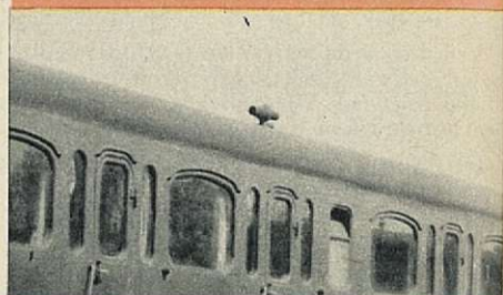
Hieronder : ventilator « Chenard » waarmee de toiletten van een rijtuig Nord-Belge zijn uitgerust.
