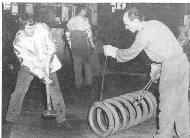
Fig. 3.16 De afgewerkte veer wordt op de grond in bewegingsloze lucht afgekoeld
