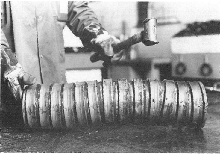
Fig. 1.49 Losmaken met koperen hamer van de ringen van een elastisch element RINGFEDER voor nazicht
