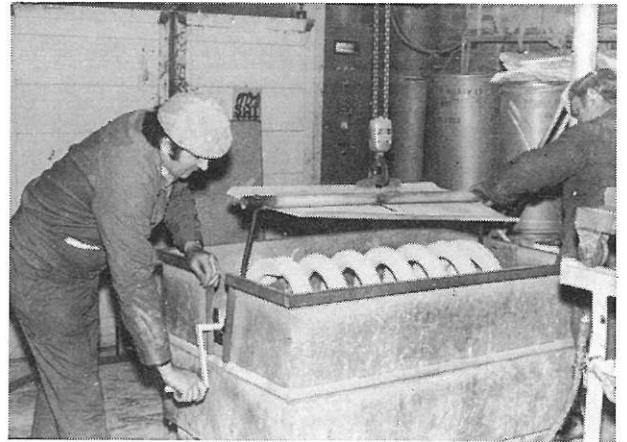
Fig. 7.8 Dompeling van de veer in het wervelsinterbad
