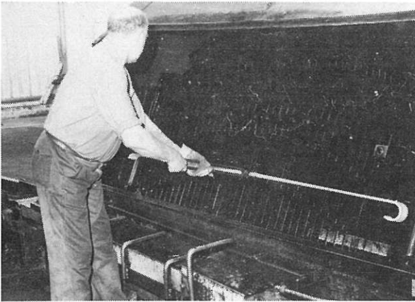
Fig. 2.29 Plaatsing van het te verbuigen blad tussen de kaken van de machine
