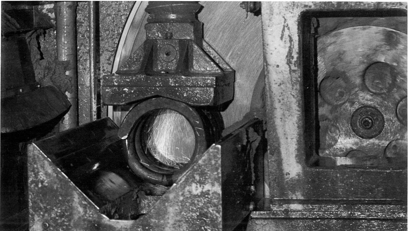
Fig. 3.17 Slijpen van de veersteunvlakken ( cliché Cockerill)
