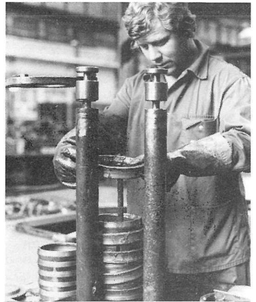
Fig. 1.50 Na nazicht en eventuele vervanging van de ringen, hersamenstelling van het geheel in een montagegabarit
