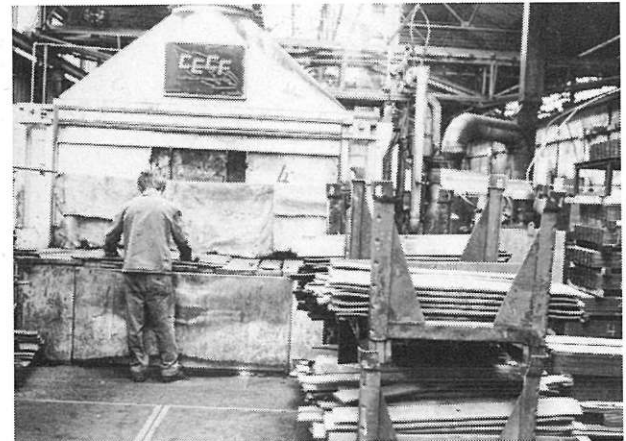
Fig. 2.8 Laden van de veerbladen in de verwarmingsoven vooraleer over te gaan tot het verbuigen en het harden in olie
