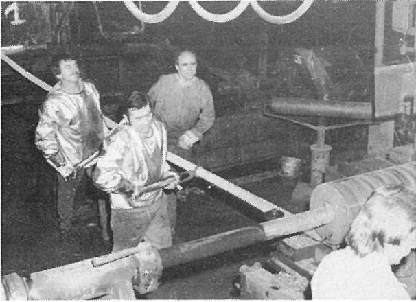
Fig. 3.7 De staaf met een diameter van 60,7 mm en een ontwikkelde lengte van \pm 10 m wordt uit de verwarmingsoven gehaald en in het oog van de wikkeltrommel gevat
