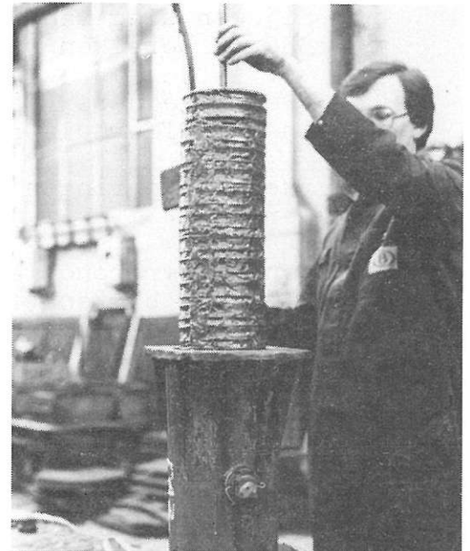
Fig. 1.52 Plaatsing van de opstapeling in de plunjer
