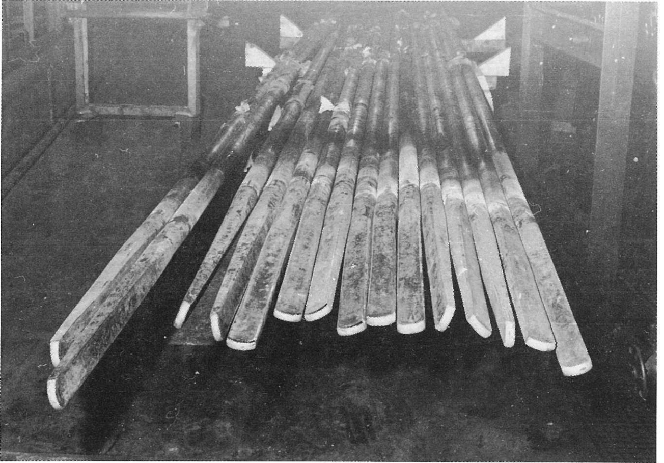
Fig. 3.6 Ontkorste staven met vooraf gesmede uiteinden die de veerbasis zullen vormen
