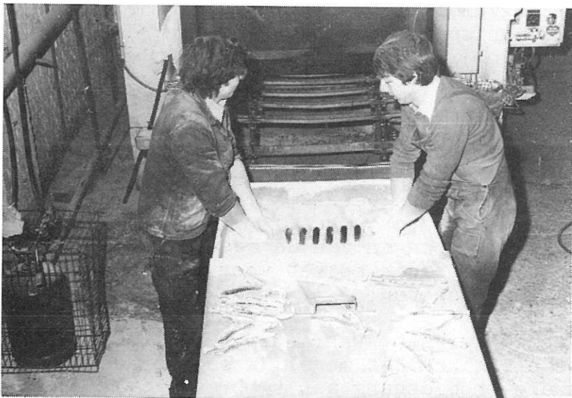
Fig. 7.6 De gerilsaniseerde veer die uit het wervelsinterbad komt, wordt daarna in een waterbad gekoeld dat ernaast opgesteld is
