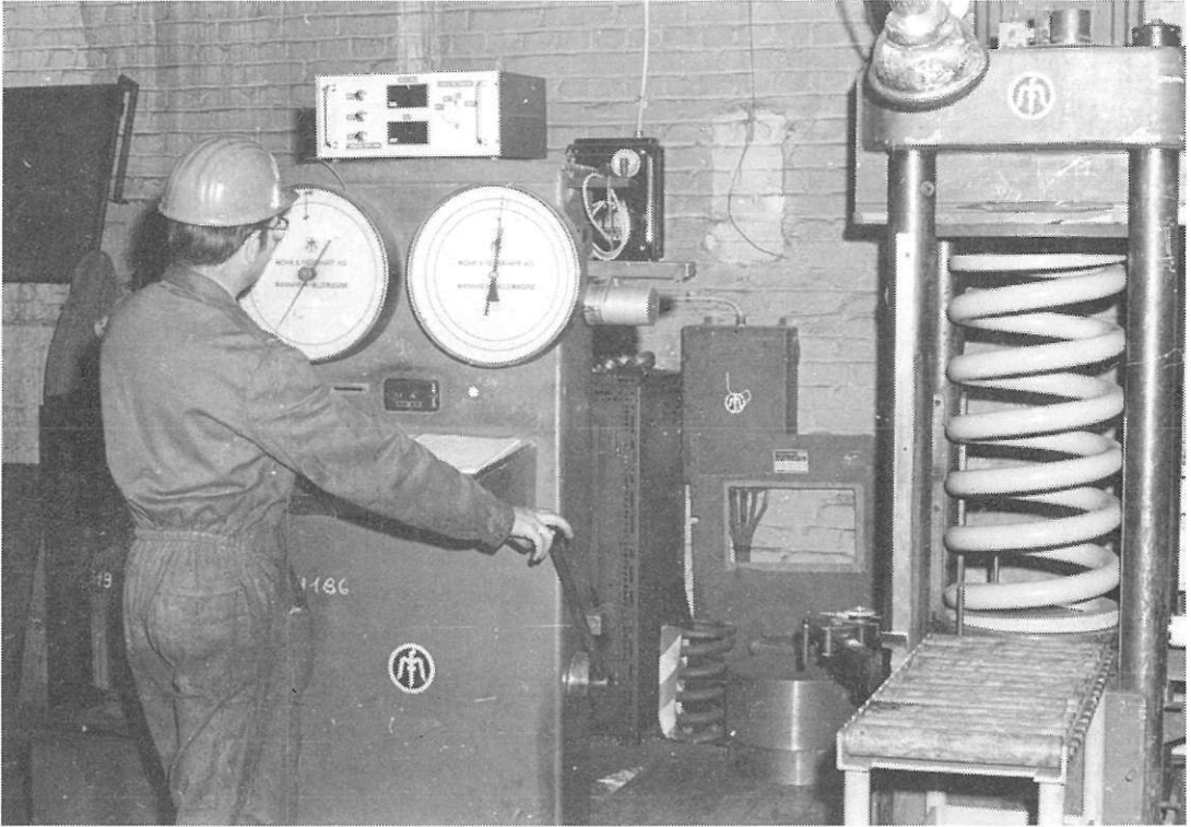
Fig. 3.18 Proefbank voor het ijken van de veer
