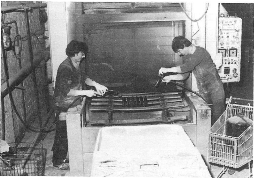
Fig. 7.4 Kleine ophangingsveer die met de hand uit de oven genomen wordt, na verwarming gedurende 45 minuten op een temperatuur die 300^{\circ} niet overtreft
