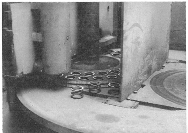
Fig. 4.8 Drukveren tijdens het slijpen
