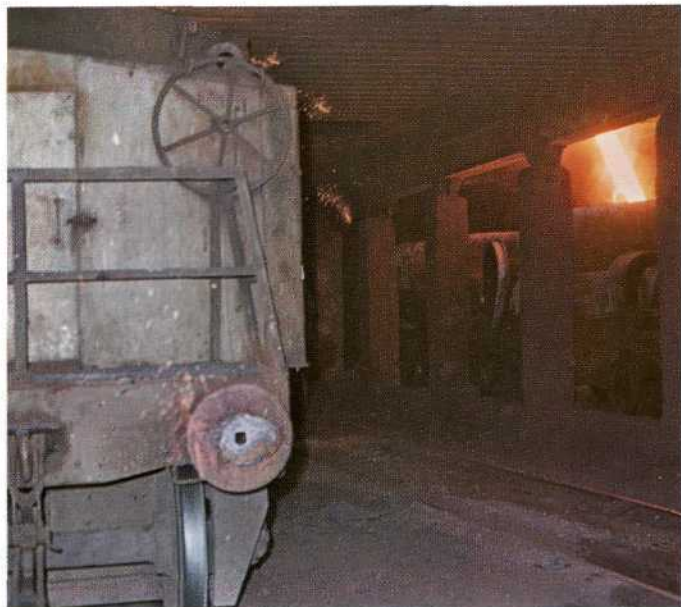
Ruwijzergietpan (op de voorgrond) en slakkenaftap in een slakkenpan (humpen).
