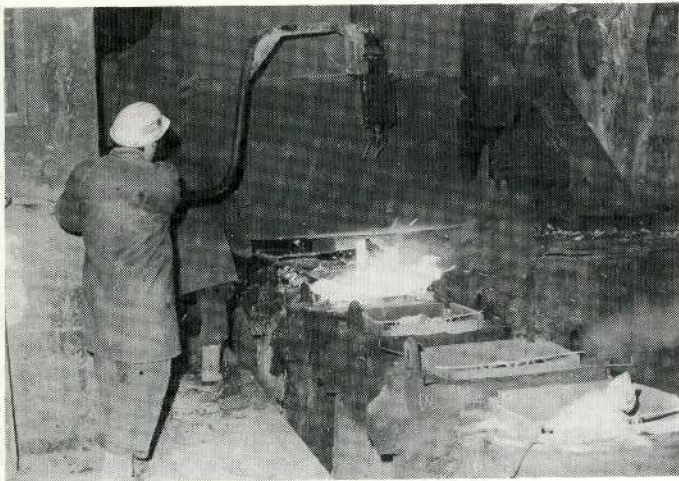
Figuur 4.29 Vallend gieten van het staal in gietblokken voorzien van blokmutsen.
