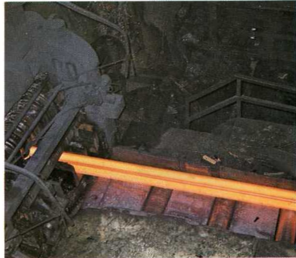
Walsen van een spoorstaaf.
