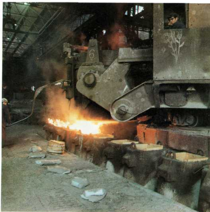
Vallend gieten in gietvormen met blokmuts.
