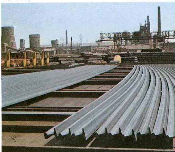
Afkoeling van gewalste spoorstaven op de koeltransporteur vóór de rollenrichtmachine.
