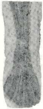
Figuur 1.37 Zwavelprint van het lijf van een golfspoorstaaf.
