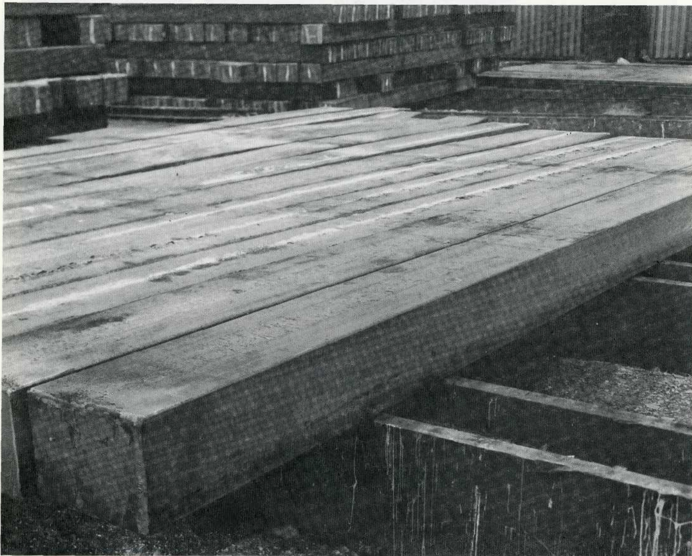
Figuur 11.8 Kontinu gegoten railblooms met een doorsnede van 330 x 254 mm.
