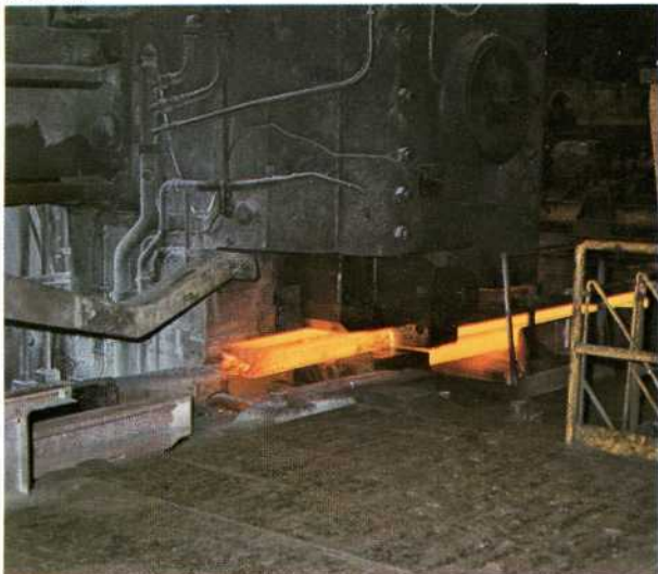
Knippen van de bloomkop met de hydraulische kopschaar.
