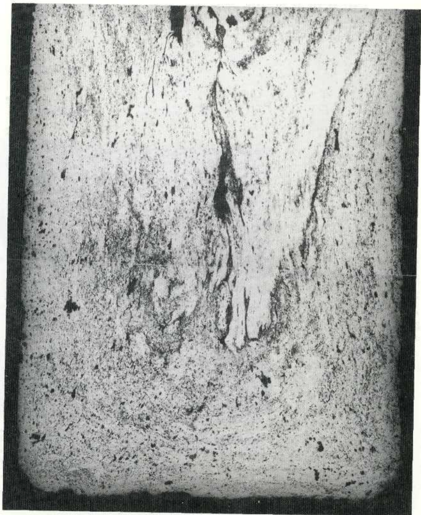
Figuur 1.40 Oberhofer-etsing van het onderste gedeelte van het lijf van de zwavelprint van fig. 1.39, 4,3 x vergroot.
