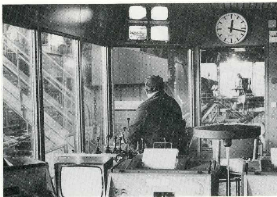
Binnenzicht van de stuurcabine die de ontlading van de doorwarmde blooms beveelt. Zicht in de richting van de ontladingsluiken.
