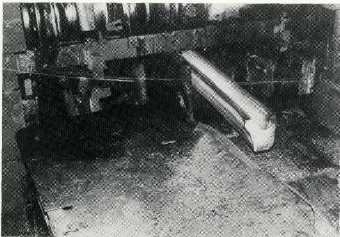
Figuur 5.4 Derde doorgang: kloven van de bloom.
