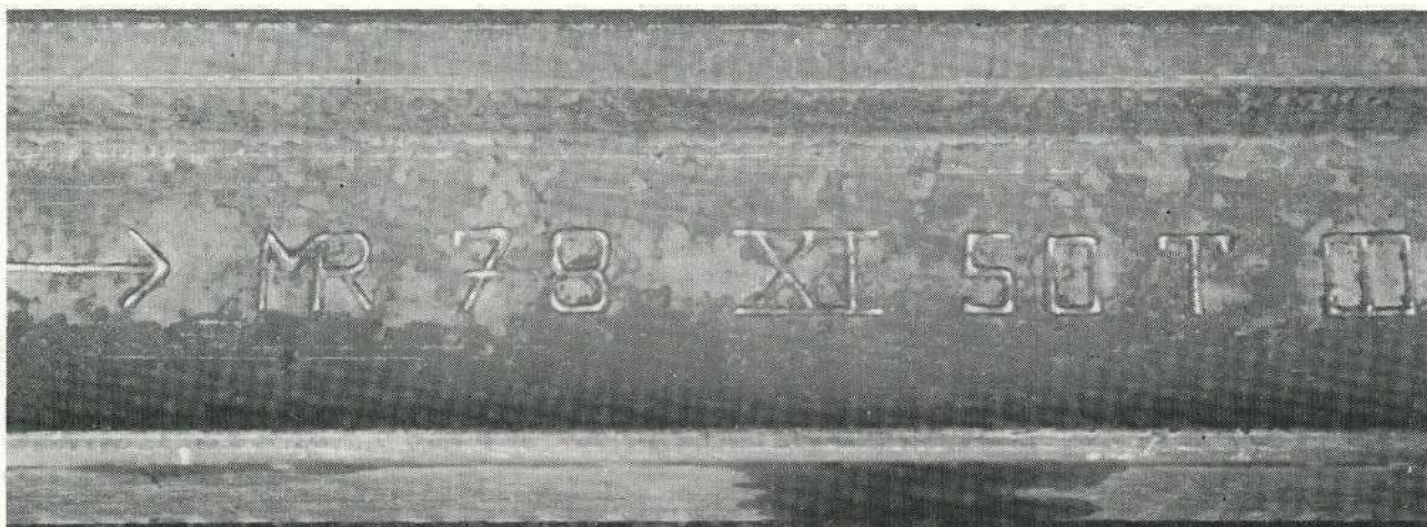
Figuur 7.13 Herkenningsmerken van het walsbedrijf. → walsrichting Métallurgique et Minière de Rodange- Athus — jaar 1978 — profiel 50 t — oxystaal.
