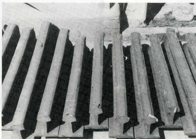
Figuur 7.14 Kopschokproefmonsters vóór de proef.
