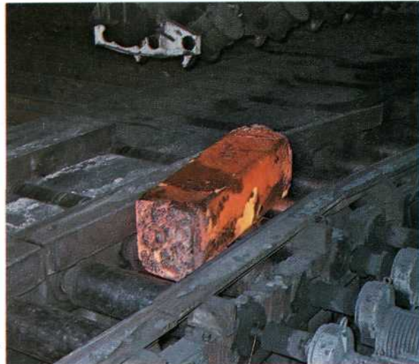
Doorgewarmde blok op de rollenbaan die het naar de blooming voert.
