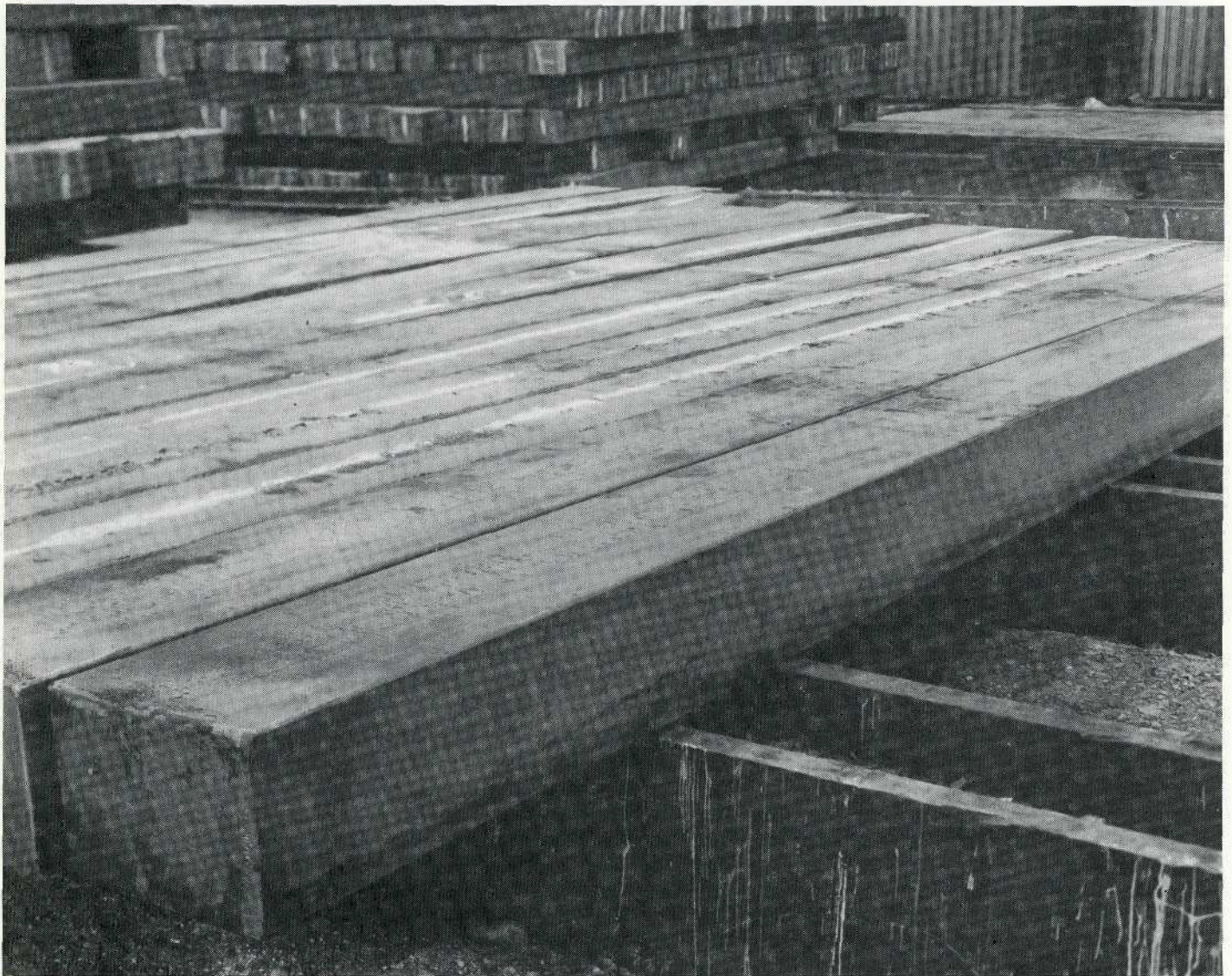
Figure 11.8 Blooms à rails de coulée continue ayant une section de 330 x 254 mm.
