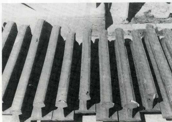
Figure 7.14 Chutes de tête destinées aux essais de choc.
