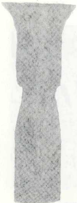
Figure 1.39 Macrographie de l'âme d'un rail à traits de Jupiter. Le métal est assez homogène.
