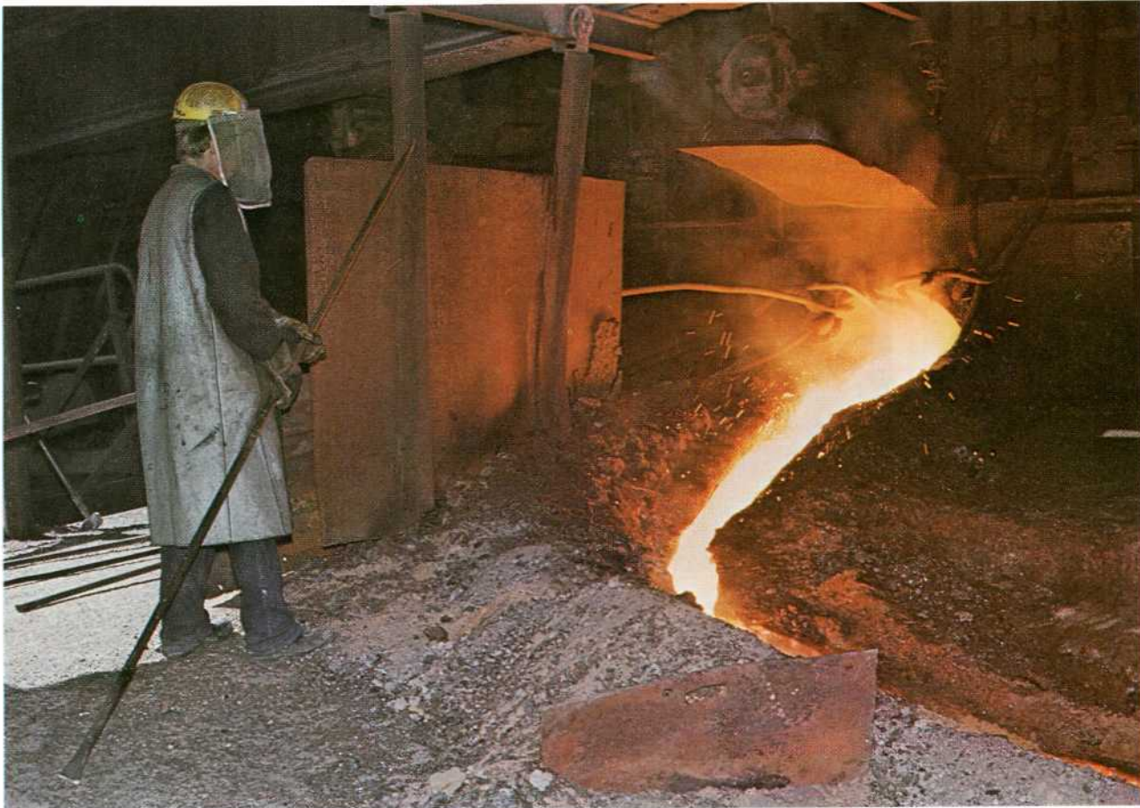
Coulée du haut-fourneau.
