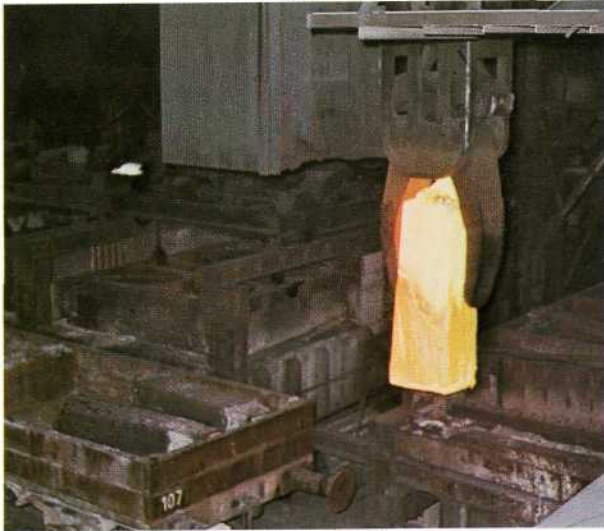
Sortie d'un lingot chaud hors d'une cellule pits.
