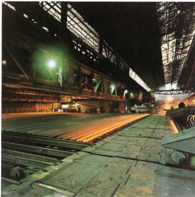
Étalage des barres sur le refroidisseur à longerons mobiles.
