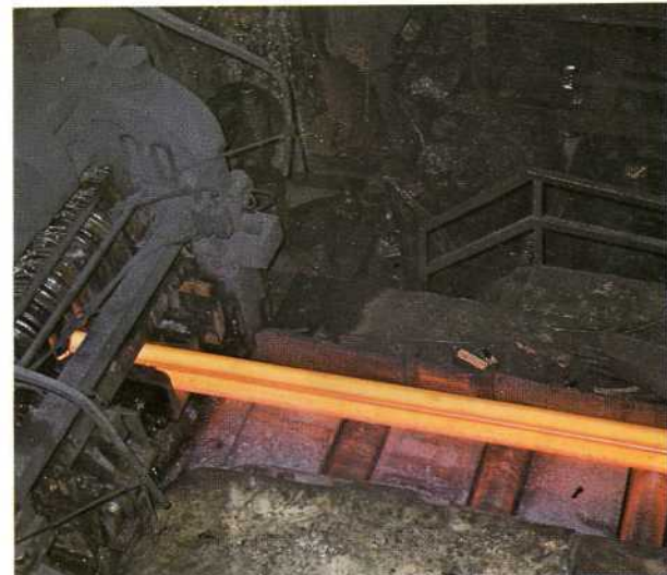
Laminage d'un rail.
