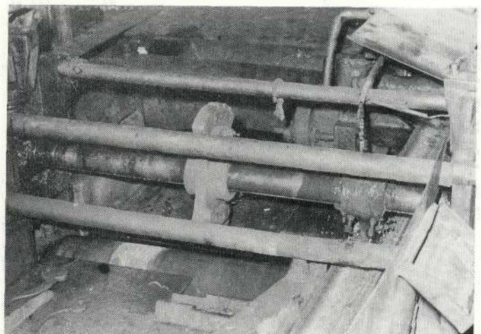
Figure 5.16 Galet de marquage automatique à chaud.
