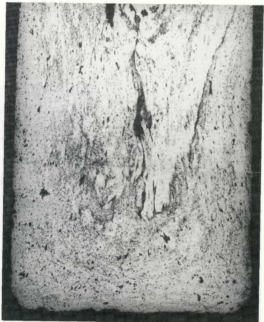
Figure 1.40 Attaque Oberhofer de la zone inférieure du rail de la fig. 1.39.
