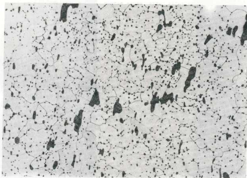
Figure 1.42 Micrographie en travers du même échantillon. Attaque au nital, grossissement 100 X. Les scories se dessinent comme des agrégats noirs.
