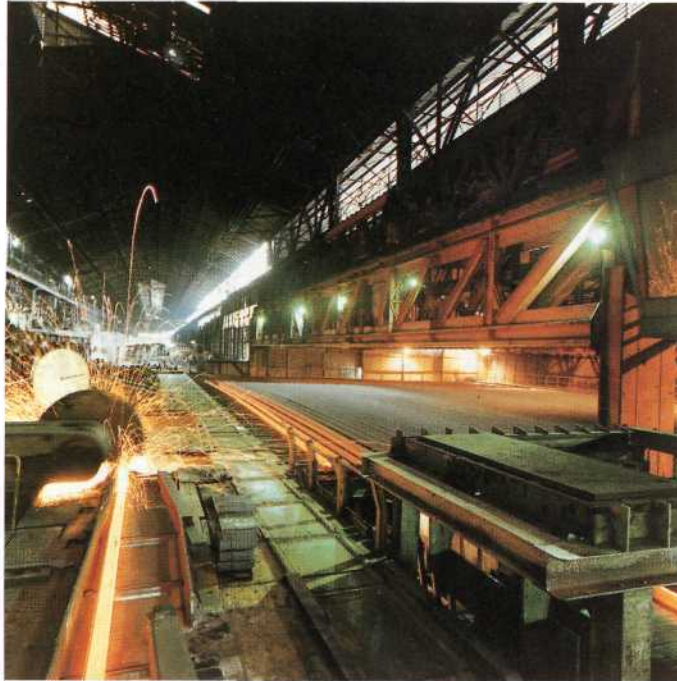
Sciage à chaud de la barre laminée.
