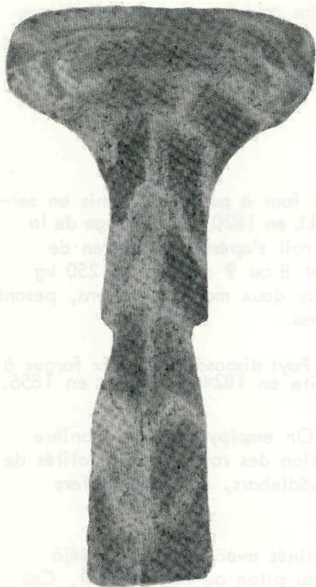
Figure 1.35 Macrographie d'un rail ondulé (18 kg/m - 1835) en fer puddlé. La partie centrale plus foncée est constituée par des mises verticales de métal plus riche en soufre.
