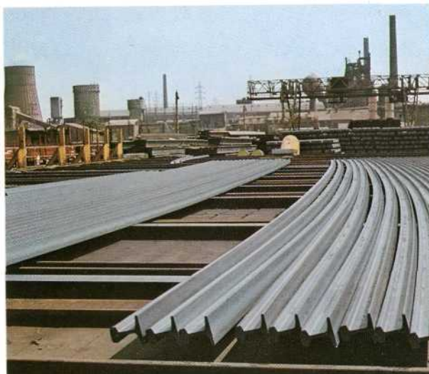
Refroidissement sur l'étendage avant la dresseuse.
