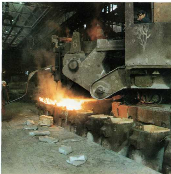
Coulée du métal en chute dans des lingotières masselottées.
