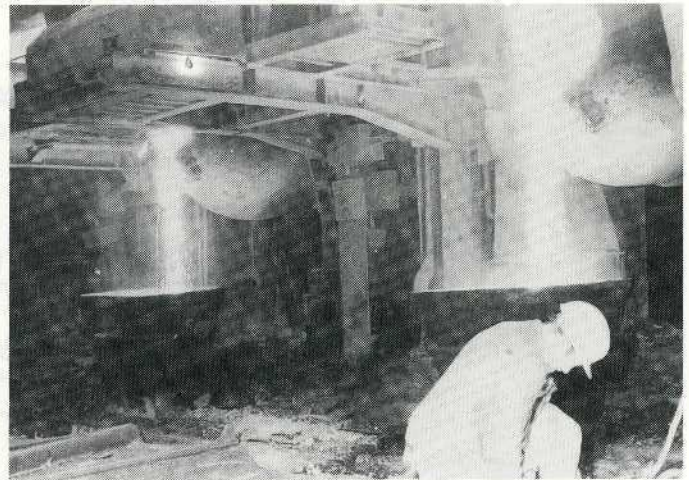
Figure 4.22 Convertisseur OBM en cours de décrassage.
