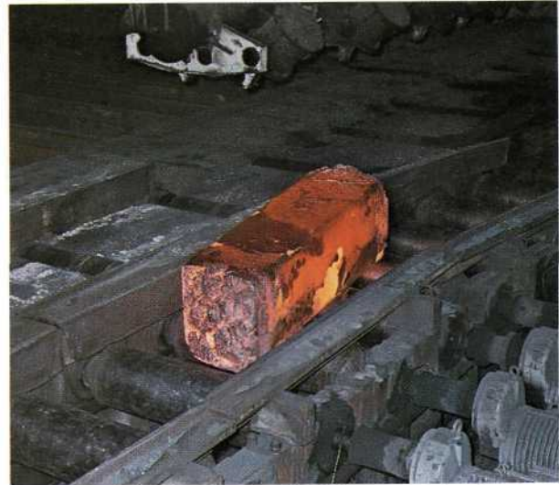
Lingot chaud amené par le convoyeur au blooming.
