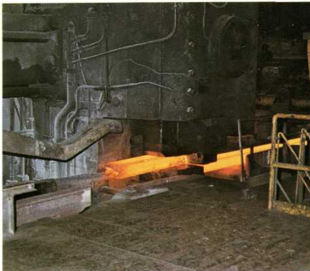
Chutage d'un bloom à la cisaille hydraulique.
