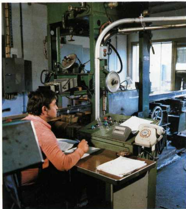
Contrôle ultrasons en continu des rails.
