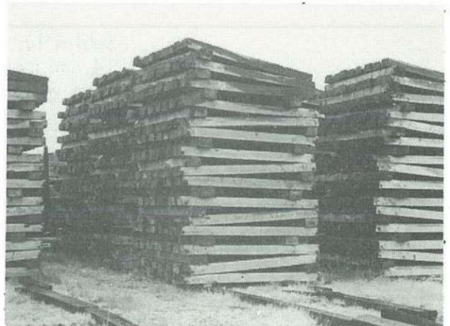
Fig. 27 Empilage en Z de traverses en hêtre.
