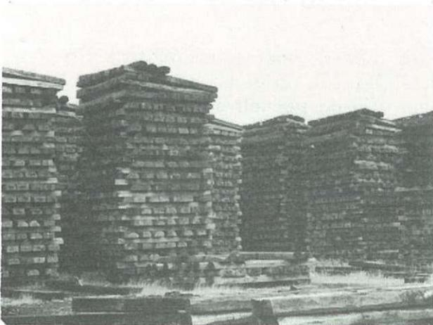
Fig. 28 Empilage aéré de traverses en chêne.
