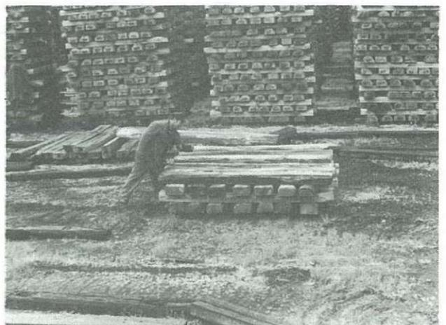
Fig. 21 Empilage provisoire en piles aérées.
