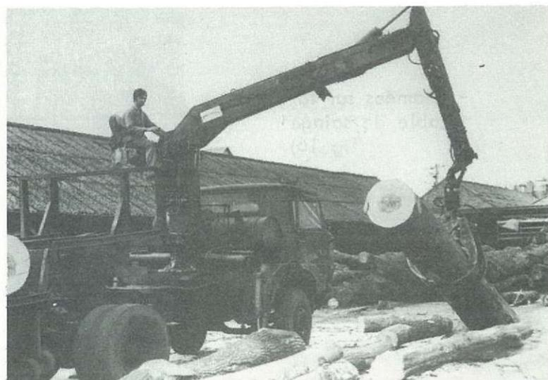
Fig. 13 Transport des billes vers l'écorceuse.
