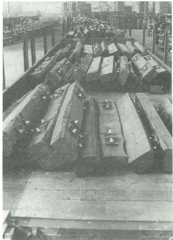
Fig. 56 Train de wagons chargé de traverses prêtes à l'expédition.
