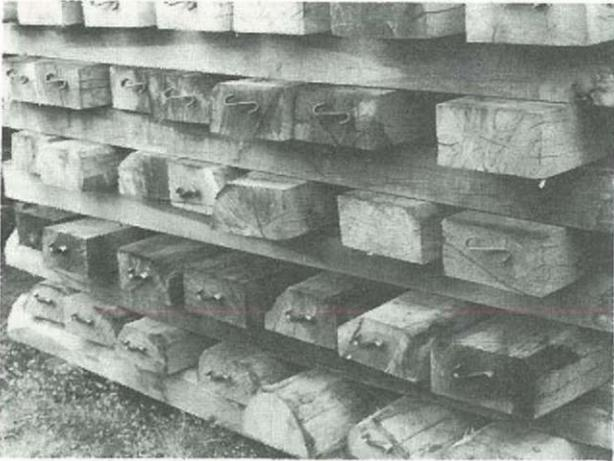
Fig. 24 Renforcement des extrémités à l'aide d'esses.
