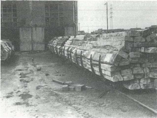
Fig. 42 Stel wagentjes met ingekepte en geboorde dwarsliggers vóór de creosoteerautoclaaf.
