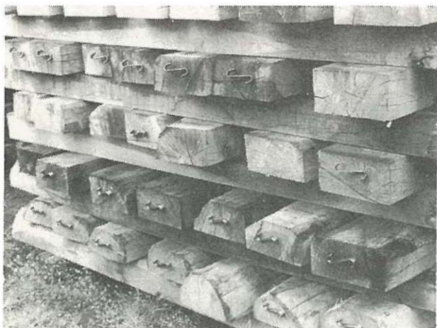
Fig. 24 Versterking van de uiteinden met een S-ijzer.
