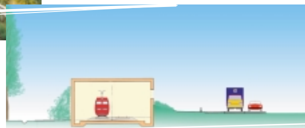
Op plaatsen waar bomen op de spoorlijn kunnen terecht komen, rijden de treinen in een koker met dakconstructie.
