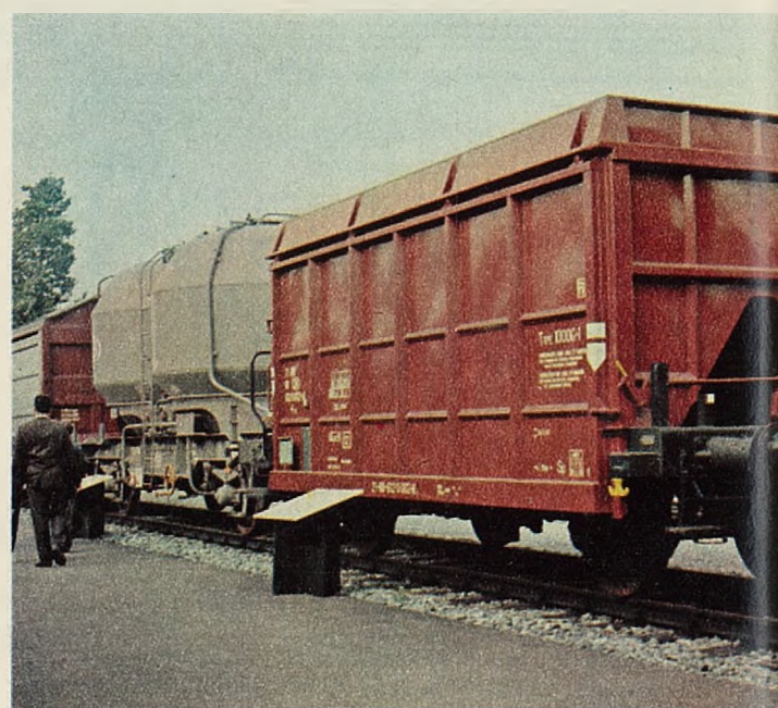
Au premier plan, wagon couvert à dos d'âne pour le transport de schlamme très collant ; il est équipé de commandes automatiques pour l'ouverture des portes, le déchargement et la fermeture des portes sans arrêt du véhicule (durée de l'opération complète : deux minutes). Derrière, wagon à vidange pneumatique (du type Polysins) pour le transport de produits pulvérulents : ciment, chaux en poudre, sable blanc séché...
