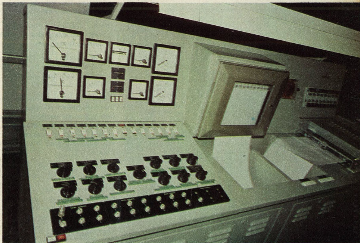
Totaalbeeld van het registreerapparaat, de compensograaf (in het midden) en de bijbehorende uitrusting.
