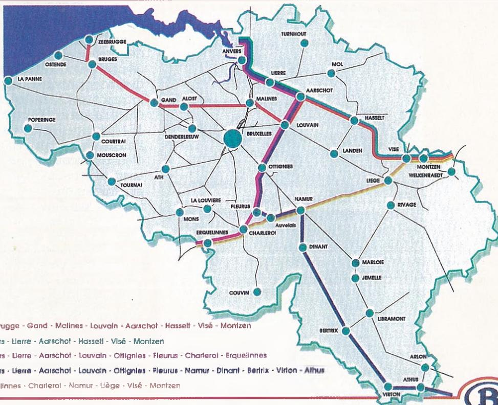
L'électrification en 25 000 volts de l'axe Athus-Meuse impliquera la création de zones de séparation aux endroits de relais avec le 3 000 volts.
