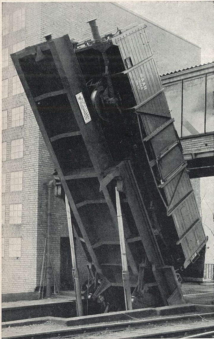
Figuur 3 Eenzijdig - frontale wagenkipper met elektro-hydraulische aandrijving.
