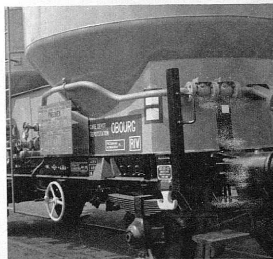
En haut : le raccord d'air comprimé du wagon citerne et la roue de commande du frein à vis.
