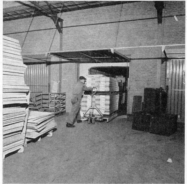
Les palettes chargées sont amenées dans le camion au moyen d'un transpalette.
