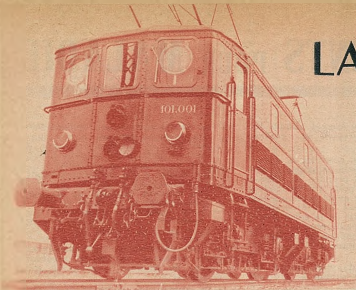
La première locomotive électrique 100 % de construction belge, destinée à la ligne Bruxelles-Charleroi ; elle peut tirer une rame de 800 T. à 130 km/h.
