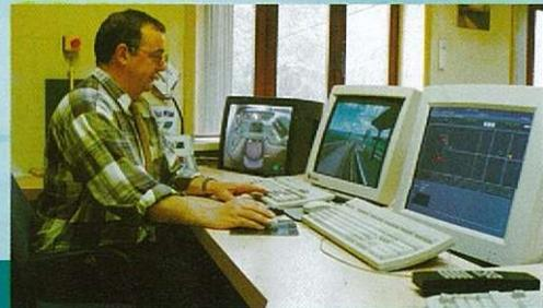
Un seul simulateur permet de confronter le conducteur à toutes les situations imaginables. Au cours d'un exercice de simulation, le conducteur parcourt un trajet donné, au cours duquel divers incidents sont provoqués: difficultés au niveau de la traction ou des freins, signalisation défectueuse, problèmes aux passages à niveau, trains en difficulté, ...
