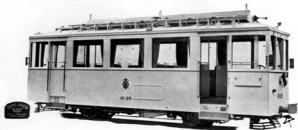
AUTOMOTRICE A 2 ESSIEUX. Moteur à essence ... 100 CV. Nombre de places ..... 60 Tara ..... 9 tonnes 300
