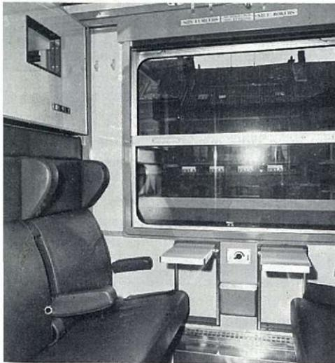
B. Intérieur d'un compartiment d'une voiture-couchettes de 2e classe (position de jour). Entre les deux tablettes escamotables se trouve la manette permettant le réglage de la température à la convenance des voyageurs.
