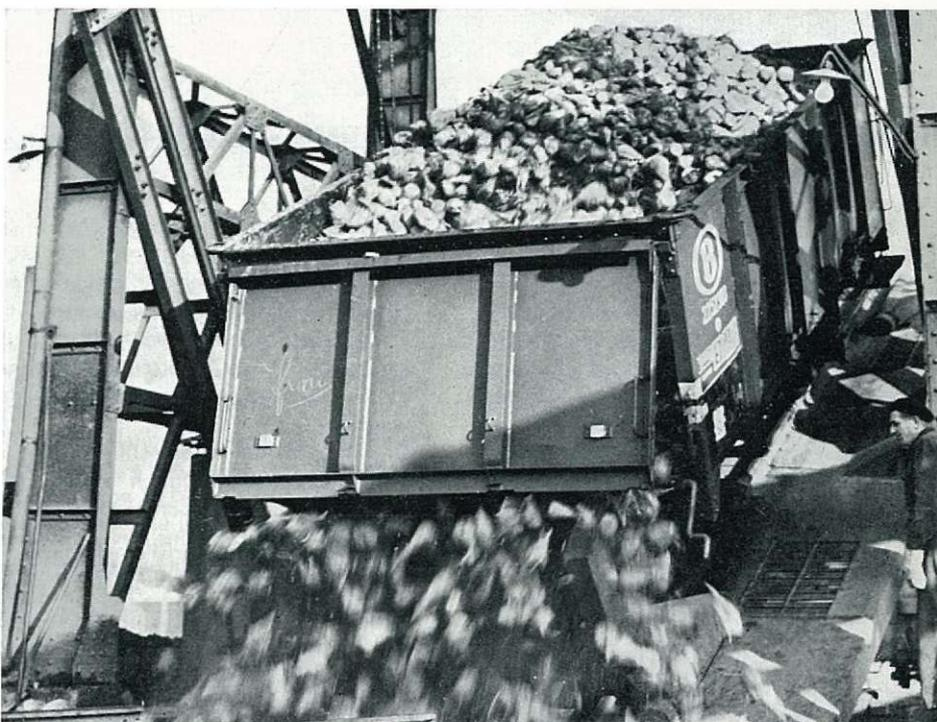
2. Tous les wagons de betteraves qui arrivent à Grimde sont culbutés. Le déchargement de chaque véhicule ne dure que quelques secondes. Les betteraves ainsi déversées dans des silos passent automatiquement, par l'intermédiaire d'une bande transporteuse, au parc de stockage où elles sont amoncelées.
