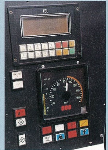
▲ «CAB-DISPLAY» : ÉCRAN VISUALISANT LES DONNÉES TRANSMISES PAR LE SYSTÈME DE SIGNALISATION
