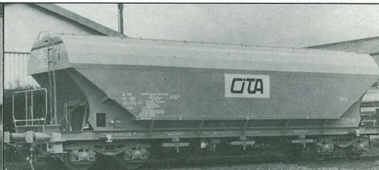
Vierassige tremelwagen voor het vervoer van granen
