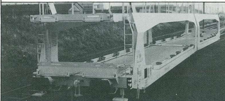
Wagon à double étage, 3 essieux, à deux éléments articulés pour le transport d'automobiles
