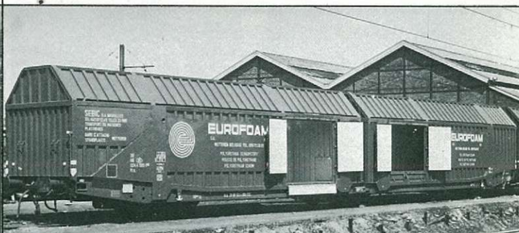
Wagon fermé, 3 essieux, à deux éléments articulés, pour le transport de produits de très faible densité
