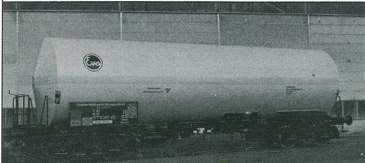
Wagon à bogies pour le transport de gaz liquéfié sous pression: oxyde d'éthylène
