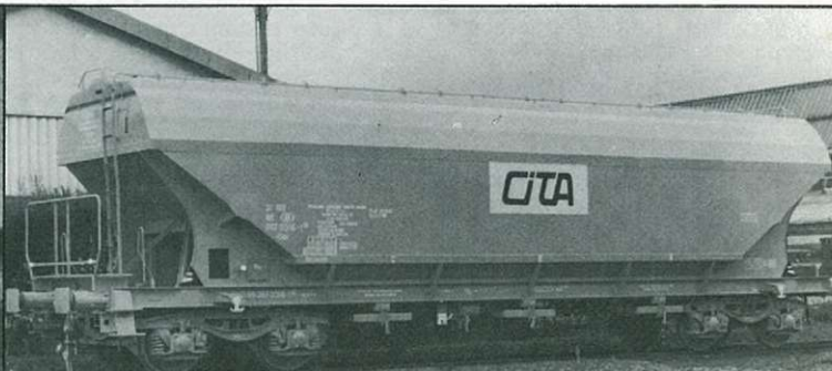
Wagon trémie à bogies pour le transport de céréales
