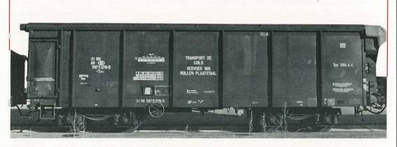
Le wagon Tahs est un wagon à toiture enroulable permettant le transport de rouleaux de tôle à axe horizontal, sans dispositifs spéciaux de calage.
