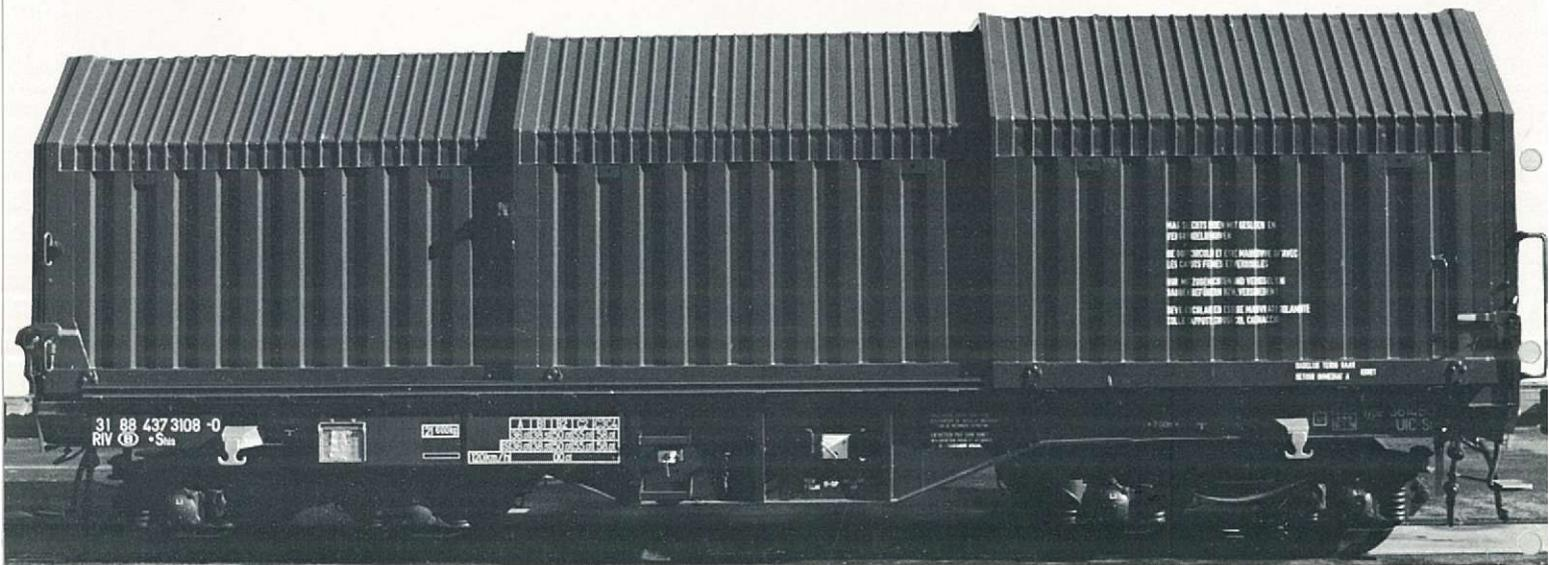
Réduction sur la demi-largeur (au milieu du wagon), donnée au tableau 2: 90 mm. Notons que nous avons ici choisi le tableau 2 parce que la longueur de la charge est inférieure à la distance entre les pivots de bogies: la machine s'inscrit donc entre ceux-ci.
