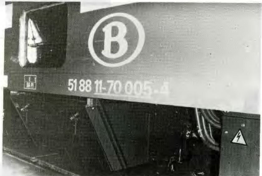
Luchtinlaat van de verwarmingsbatterij met filterkast.
