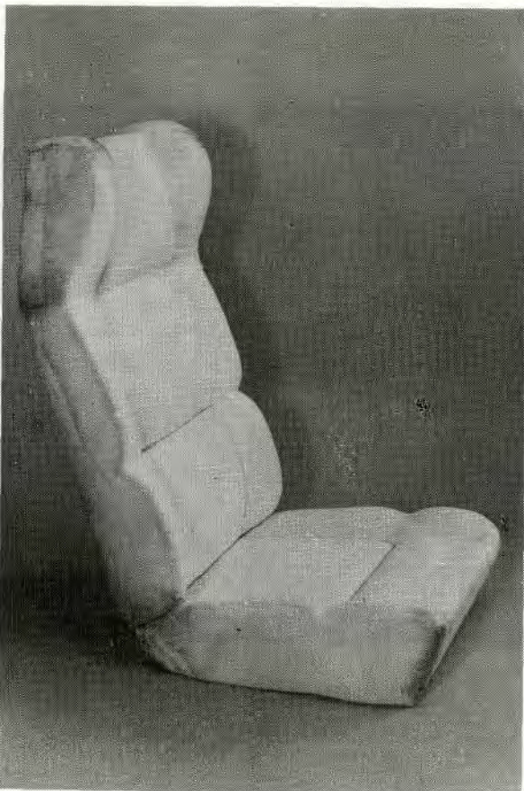
Zetel overtrokken met een brandvrije glasvezelbekleding bestreken met PVC.
