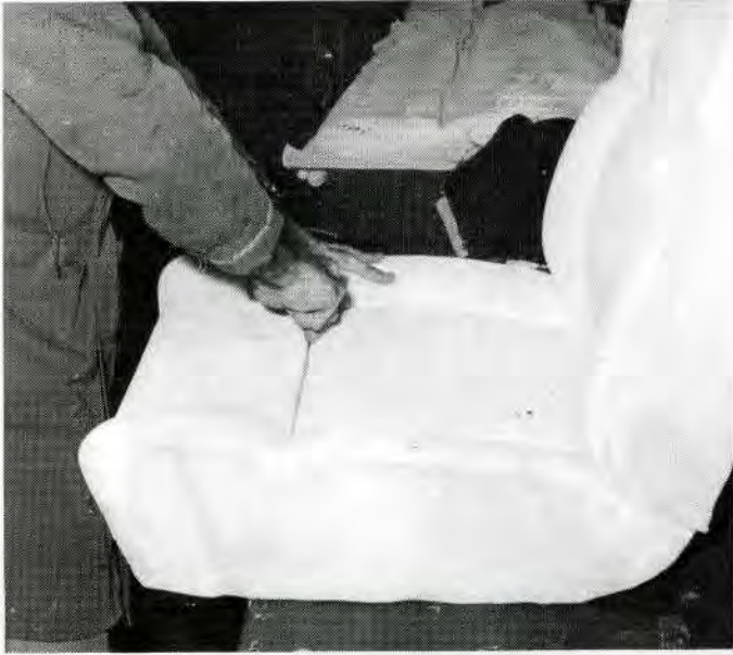
Plaatsing van de zetelhoevesvestigingsstaven doorheen de polyurethaanschuimzitting.
