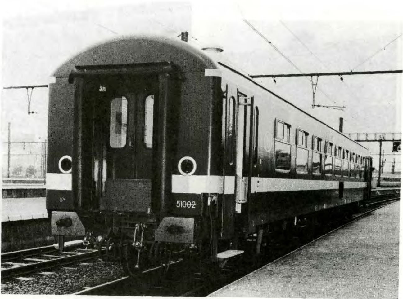
Vue d'about avec la porte d'intercirculation et appareil de choc et de traction.
