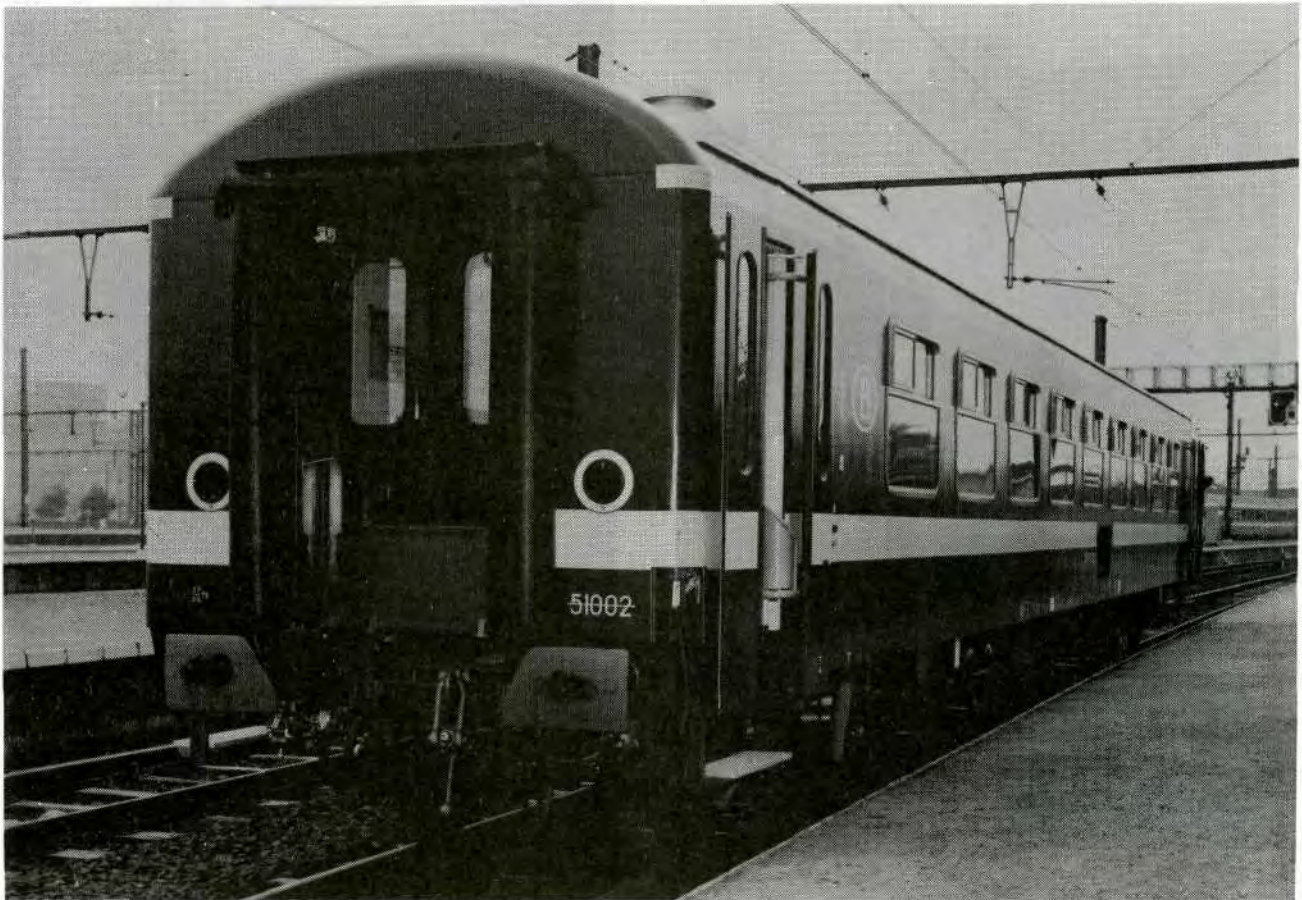
Kopuiteinde met zicht van de overgangsdeur en van de trek en stootinrichting.
