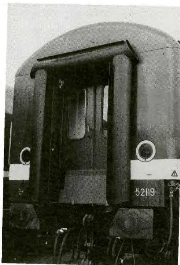
Kopuiteinde met de overgangsbullen. Rechterzicht.
