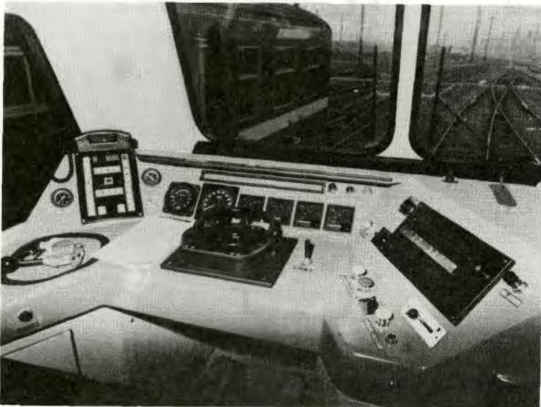
Le poste de conduite dont la disposition des manipulateurs et des cadrans a été étudiée ergonomiquement.
