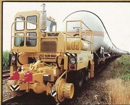
95 TMC: de grote broer uit de reeks Trackmobile, duwt en trekt tot 5.000 ton.
