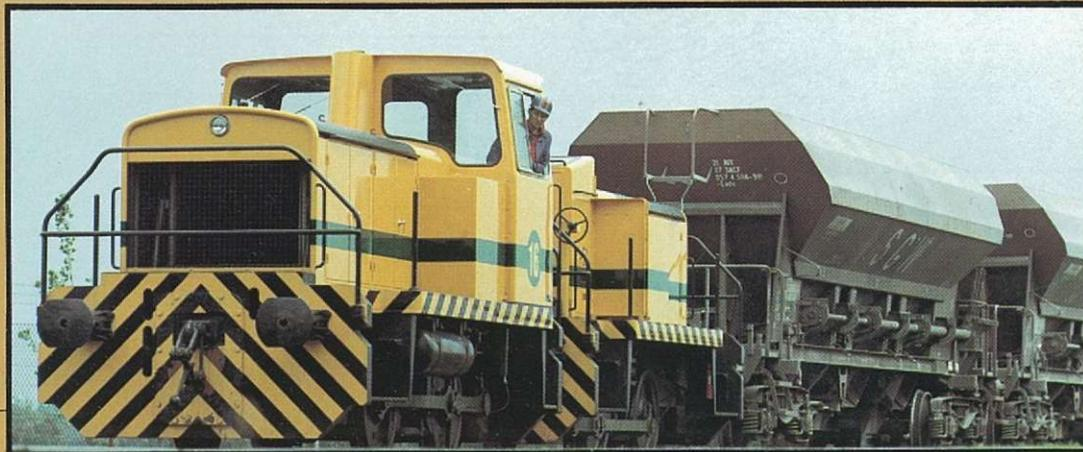
Ensemble de traction à 4 essieux de Cockerill Sambre (0-4-0/0-4-0): locotracteur accouplé à un tender à moteur.
