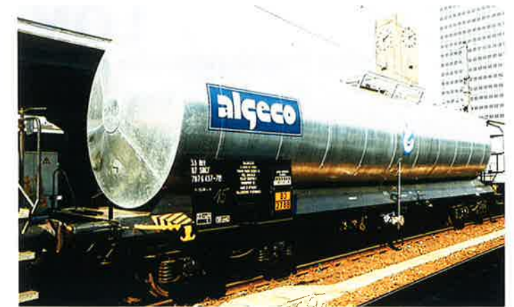
Wagon inox calorifugé et réchauffé (ALGECO) produits chimiques divers longueur hors tout : 15,30 m capacité : 600 hl tare : 24 t distance entre pivots de bogies : 10,26 m charge maximale : 56 t en C
