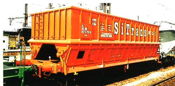
Wagon-trémie ouvert à déchargement bilatéral instantané (CAIB) produit: minéral de fer capacité: 40 m 3 tare: 21,25 t charge maximale: 58,7 t (peut être adapté pour 22,5 t/essieu) longueur hors tout: 11,04 m écartement entre pivots: 6,00 m
