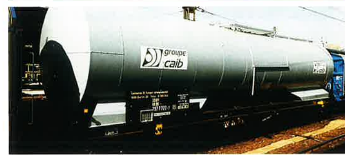
Wagon citerne en acier inoxydable, réchauffeur extérieur et isolation (CAIB) produits: liquides chimiques tels que inflammables, corrosifs et toxiques capacité: 70 m 3 tare: environ 23,6 t charge maximale: 56,4 t nature acier: Inox 1.4541 - AISI 321 isolation: 100 mm - réchauffeur: 8 m 2 vidange: par gravité et par pression longueur hors tout: 15,24 m écartement entre pivots: 10,05 m
