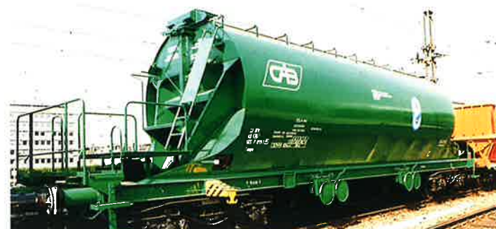
Wagon-trémie à toit basculant à déchargement central réglable (CAIB) n.b. ce wagon peut être équipé d'un revêtement intérieur produits: pondéreux capacité: 65 m 3 tare: 22,5 t charge maximale: 57,5 t longueur hors tout: 15,44 m écartement entre pivots: 10,40 m
