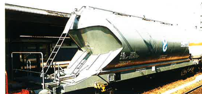
Wagon silo à déchargement pneumatique (CAIB) n.b. ce wagon peut être pourvu d'un revêtement intérieur produits: pulvérisants divers capacité: 63 m 3 tare: 21,5 t charge maximale: 58,5 t longueur hors tout: 15,24 m écartement entre pivots: 10,20 m
