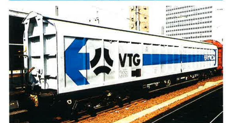
Wagon fermé de type ferry-boat (VTG) produits : tous produits palettisés ou non longueur : 22,20 m capacité : 116 m 3 (20,94 x 2,44 x 2,40 m) tare : 26,7 t distance entre pivots de bogies : 16,66 m charge maximale : 54 t en C surface utile : 51 m 2
