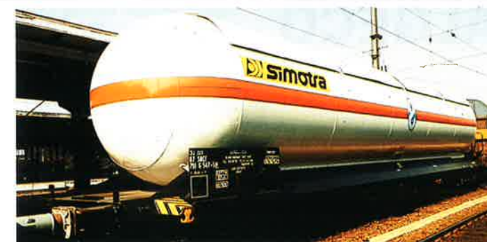
Wagon citerne pour gaz liquéfiés (CAIB) capacité: 111 m 3 pression d'épreuve: 25,5 bars tare: 34 t charge maximale: 46 t longueur hors tout: 19,20 m écartement entre pivots: 14,10 m
