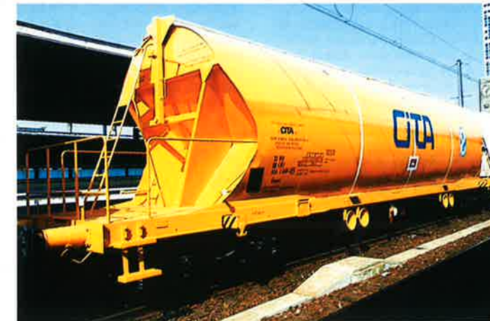
Wagon trémie pour pulvérulents en vrac (CITA) produits : céréales, dérivés et sucre revêtement alimentaire - déchargement axial tare : 22 t capacité : 93 m 3 charge maximale : 58 t longueur hors tout : 17,40 m
