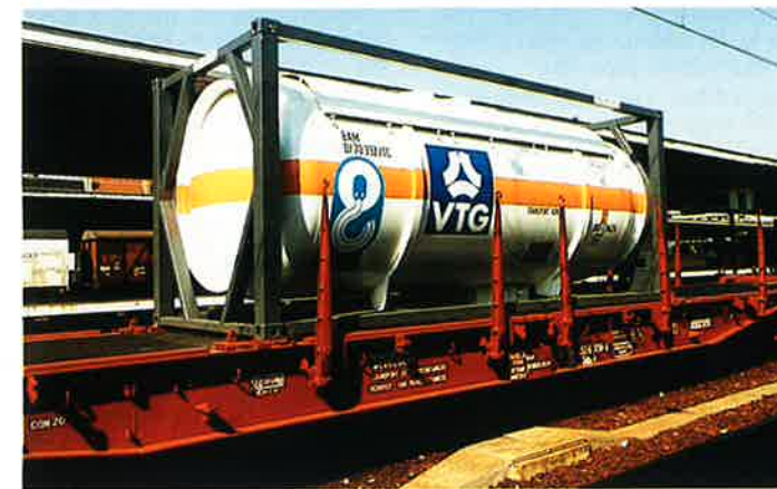
Tank Container de 20 pieds (VTG) produits : produits chimiques capacité : 20 à 24 m 3 isolation : 50 mm tare : 3,5 à 4,2 t selon modèle charge maximale : 24 t
