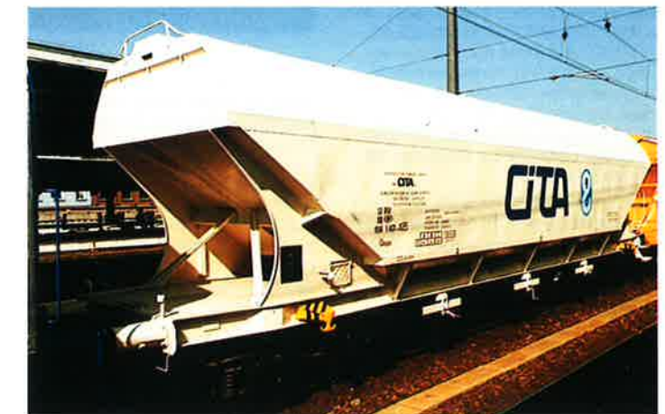
Wagon trémie pour vrac (CITA) produits : céréales et dérivés déchargement axial tare : 20 t capacité : 96 m 3 charge maximale : environ 60 t longueur hors tout : 15 m
