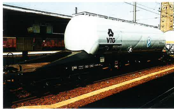
Wagon-citerne pour pulvérulents (VTG) produits : granuleux et pulvérulents longueur : 18,64 m capacité : 71 m 3 tare : 24 t distance en pivots de bogies : 13,40 m charge maximale : 56 t en C, 66 t en D
