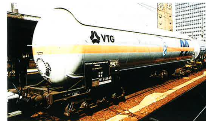
Wagon pour gaz liquéfiés sous pression (VTG) produits : LPG longueur : 17,74 m capacité : 107 m 3 charge maximale : 46,7 t en C, (54,7 t en 22 t/essieu) tare : 33,3 t distance entre pivots de bogies : 11,80 m
