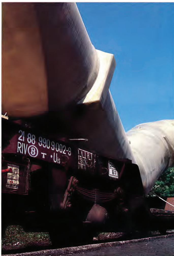
Uis, een tweassige dieplader voor bepaalde sterk gebogen stukken
