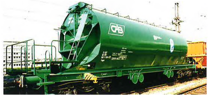
Type tremelwagen met zwenkdak met centrale lossing (regelbaar debiet) (CAIB)
