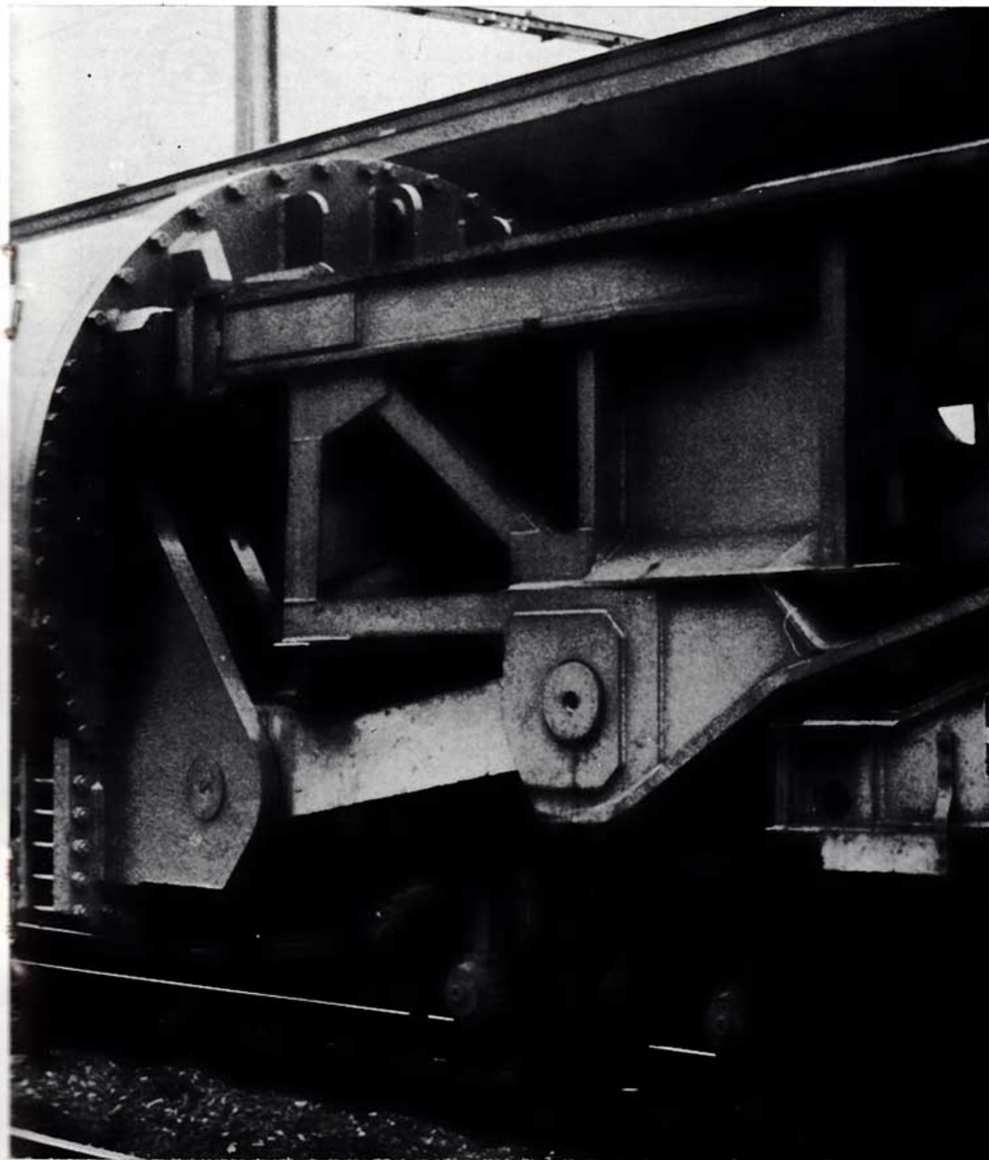
Speciale deksels vastgebout op de draagramen.
