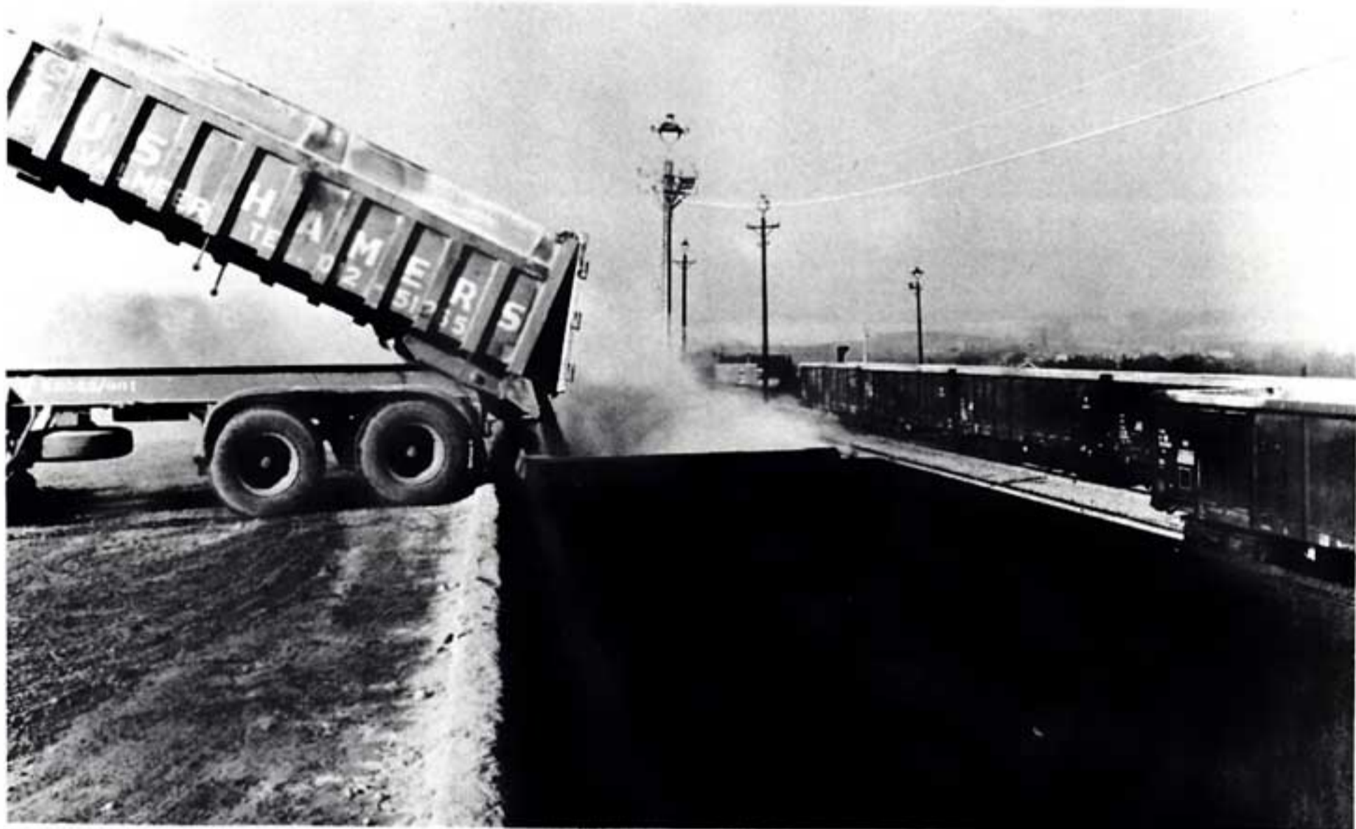
2e fase : Dank zij een heuvel of een hoog perron kippen ze het goed in de wagen.
