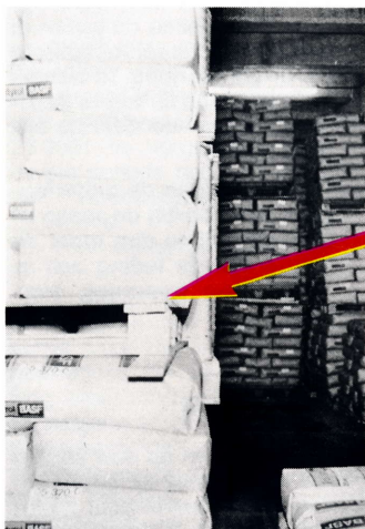
De doorzakking is te wijten aan het feit dat de doos over de kant van de pallet komt.
