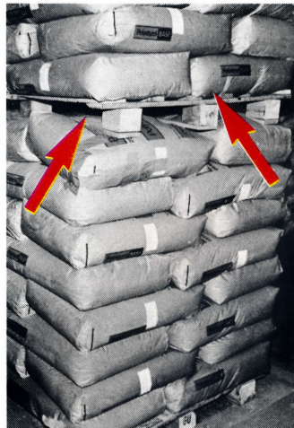
Onvoldoende stabiliteit te wijten aan de verkeerde plaatsing van de zakken.
