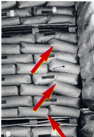
Onvoldoende stabiliteit te wijten aan de verkeerde plaatsing van de zakken.
