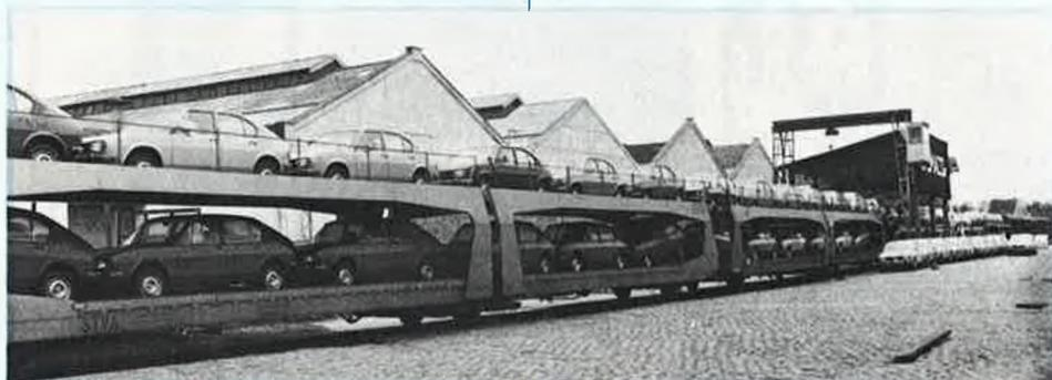
Première utilisation de cette rampe : le déchargement des voitures Alfa Romeo importées d'Italie. Les rames de wagons à deux étages sont placées devant la rampe. Des plates-formes amovibles créent entre les wagons des intercommunications qui permettent le déchargement sans manœuvre. Le wagon plat de la rampe est au niveau inférieur des porte-autos. Pour le déchargement du niveau 2, les gouttières mobiles sont posées et les voitures effectuent deux petits plonges.
