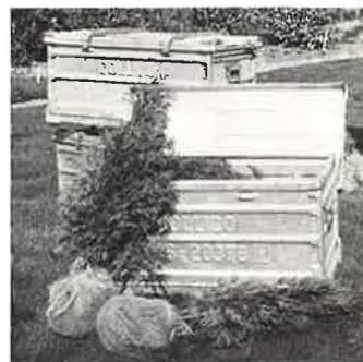
Les petits containers pour envois de détail sont des boîtes dont le volume n'excède pas 3m<sup>3</sup>. Il en existe deux types différents: les collicos (en aluminium, repliables) et les petits containers proprement dits (montés sur roulement).
