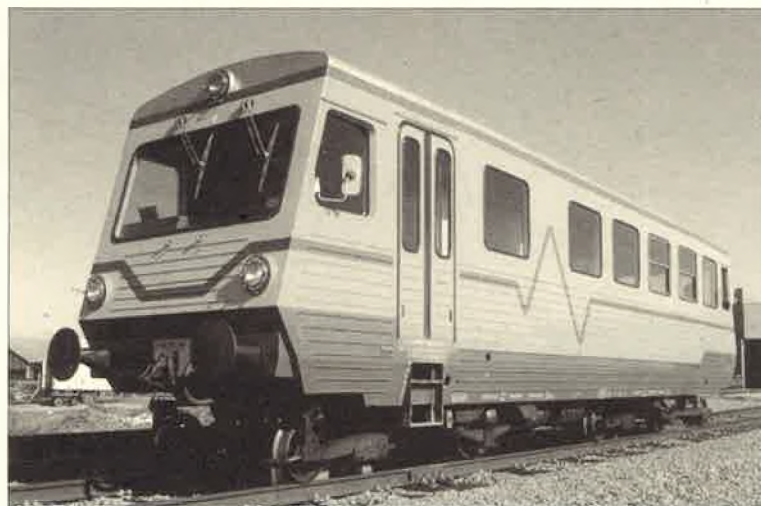
La draine de mesure M 422 qui parcourt la totalité du réseau deux fois l'an.
