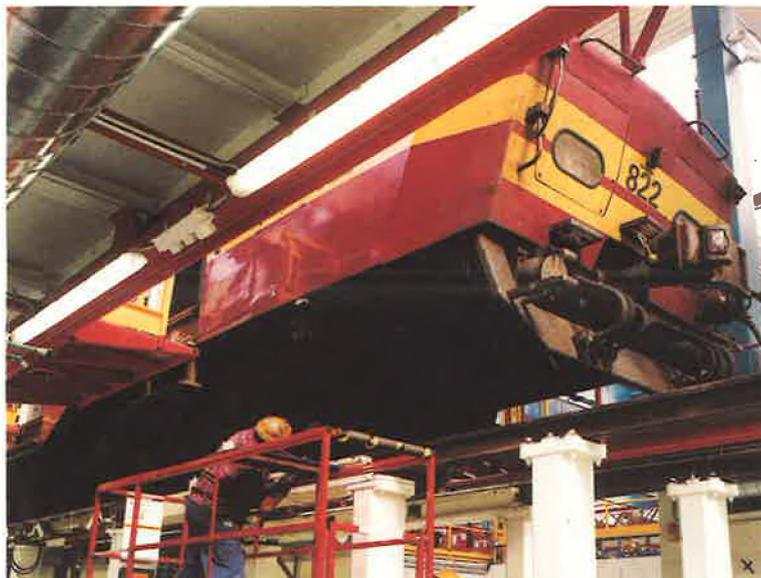
*Dans l'atelier de Charleroi, l'on remplace les essieux avariés suivant la technologie des rails éclipsables.*
