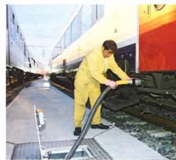
Les WC fermés d'environ 200 voitures d'AM 96 doivent être vidangés, notamment grâce au réseau de bouches fixes de vidange dont est dotée l'installation.
