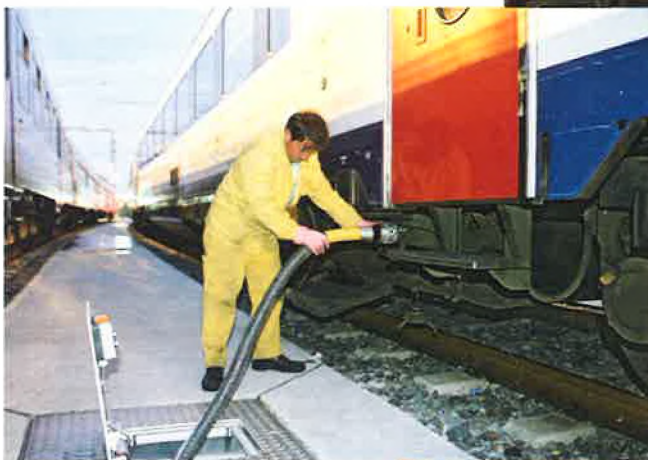
De gesloten wc-circuits van ongeveer 200 rytuigen MR96 moeten worden leeggemaakt, meer bepaald door middel van het net van vaste afvoermonden.
