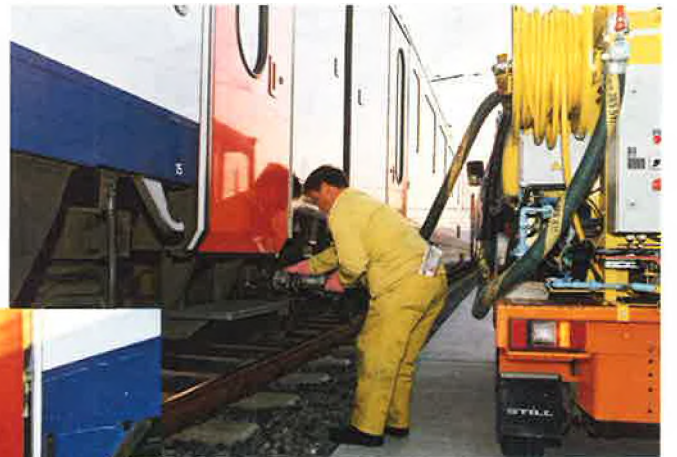
De toiletten van de voertuigen die op sporen buiten de vaste installatie staan, worden leeggemaakt met behulp van een trekker die voorzien is van een reservoir van 2 m 3 .
