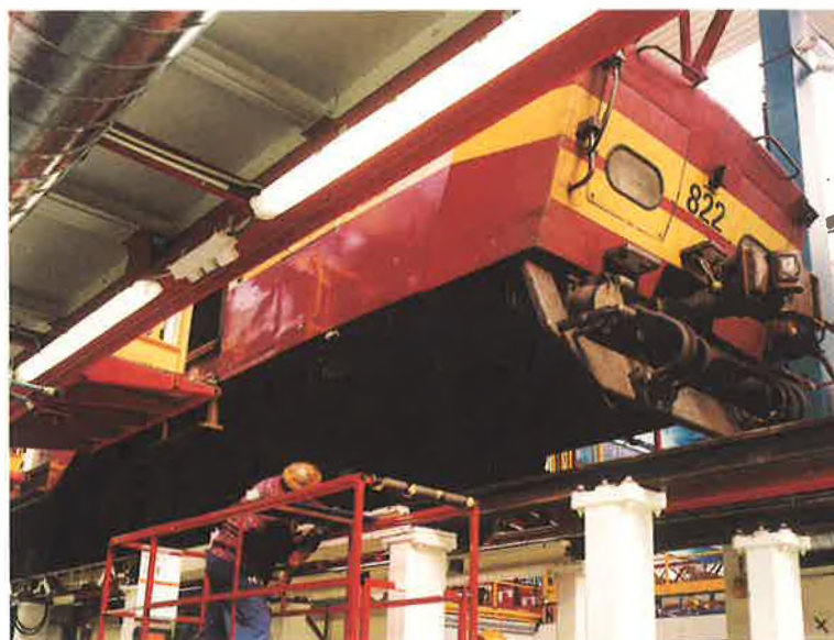
In het atelier van Charleroi vervangt men beschadigde assen d.m.v. de technologie van wegneembare rails.
