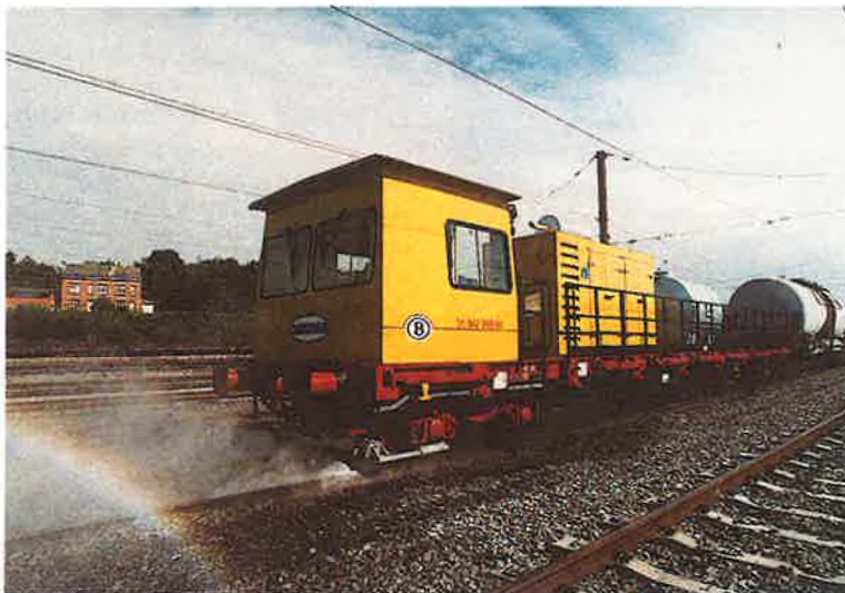
Een regenboog verschijnt waar de spoorreiniger het spoor schoonspuit.
