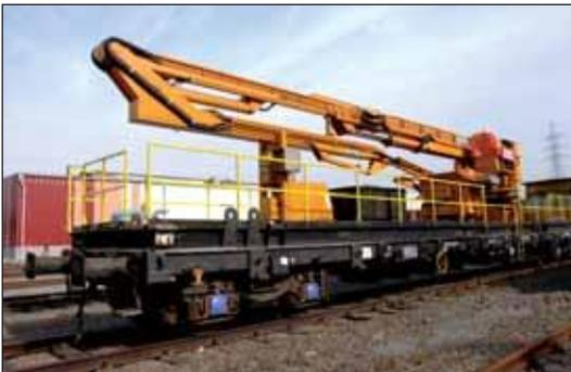
À côté des voies et des ouvrages d'art, Infrabel entretient également la caténaire. Pour cet entretien et les réparations, les équipes techniques peuvent utiliser les autorails du type ES 500. Ces machines sont équipées d'une grue et d'une plateforme hydraulique réglable en hauteur qui peut tourner à 90° à gauche et à droite.
