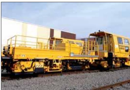
Récemment, Infrabel a acquis quatre nouvelles régaleuses du type SSP 203-2K. Au moyen de leurs panneaux mobiles, ces machines récupèrent le ballast déversé trop loin de la voie et poussent les pierres au bon emplacement. En outre, les brosses dont elles sont équipées permettent aux régaleuses de nettoyer les voies pour parachever le travail.
