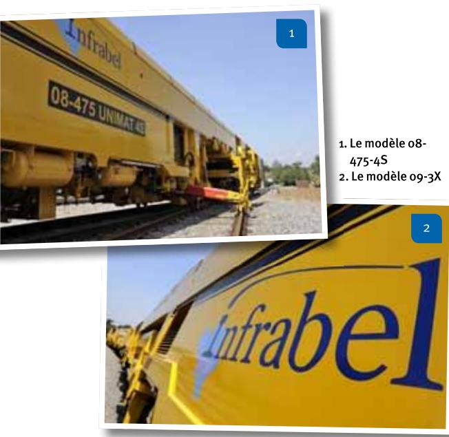
**L**es bourreuses-niveleuses-dresseuses sont utilisées pour effectuer des travaux sur les voies dont la géométrie est déformée à cause du trafic ferroviaire intense, des conditions climatiques, etc. Ces machines soulèvent les traverses, remettent la voie en place (en hauteur et en direction) et bourrent le ballast en dessous des traverses.
