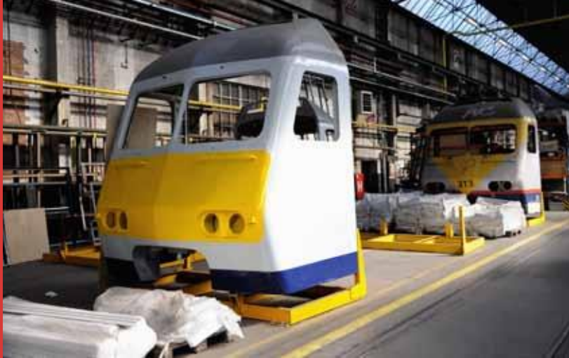
Bij de modernisering wordt de stuurcabine gedemonteerd om de roestvlekken te kunnen behandelen en te schilderen.
